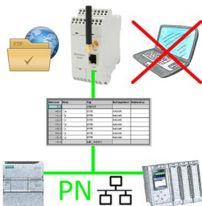
S7-SPS getriggerte DB-Sicherung/-Wiederherstellung ohne zusätzlichen PC über PN-Port auf FTP-Server
