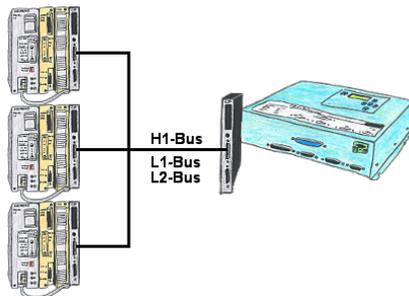
Sie haben vor ort einen existierenden L1-, L2- oder H1-Bus und müssen parallel dazu die Steuerungen programmieren? Kein Problem, einfach die Affenschaukel als Verbindung von Kommunikationsprozessor (CP) zur SPS stecken, das Tele-Network-Gerät an einem freien CP per TELE-CP-Kabel anschließen und mittels PG-Pfadanwahl entsprechende SPS-Steuerung selektieren. Hierzu wird die L1-, L2- oder H1-Bus-Option benötigt.
