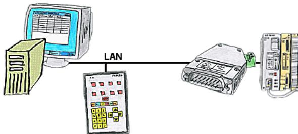
Ihr Panel hat als SPS-Schnittstelle nur eine LAN-Buchse? Kein Problem, verbinden Sie diese Buchse mit dem S5-LAN++ und stecken dieses direkt auf die PG-Schnittstelle der Steuerung. Schon steht Ihnen der Zugriff auf die Variablen und Daten der Steuerung zur Verfügung.
