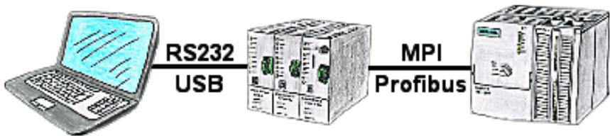
Über das TeleService-Gerät können Sie sich direkt mit Ihrem PC/Laptop seriell oder über USB-Kabel anbinden und somit ohne einen PC-Adapter oder sonstige S7-Programmierskabel direkt mit der Steuerung kommunizieren. Das USB-Kabel ist ein Standardkabel, so wie Sie es an Ihrem Drucker verwenden.
