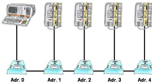
Sie müssen mehrere S5-Steuerungen so vernetzen, dass Sie zentral alle Steuerungen im Bedarfsfall ansprechen können und das Ganze ohne Änderung des SPS-Programms? Kein Problem, Sie schließen an alle in Frage kommenden Steuerungen die IBX-Klemme an, stellen in der Klemme die jeweilige Adresse (1 bis 30) ein und über die Klemme mit der Adresse 0 können Sie alle Steuerungen über die PG-Bus-Pfadanwahl ansprechen.
