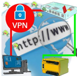
Fernwartung einer Pilz-Steuerung mit Netzwerk-Anschluss über gesicherten VPN-Tunnel und skalierbarer Firewall
