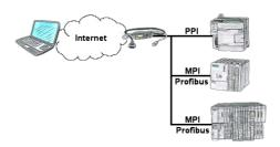
Sie haben Zugriff auf ein Netzwerk vor Ort und Ihre SPS-Steuerung hat aber keinen LAN-Anschluss? Kein Problem, stecken Sie auf Ihre SPS-Steuerung das S7-LAN bzw. MPI-LAN-Kabel und Sie haben sofort Zugriff auf die Steuerung über die Ferne.
