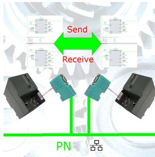
S7-Steuerung mit MPI/Profibus an S7-Steuerung mit MPI/Profibus koppeln ohne den Bus zu mischen
