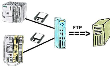
Sie benötigen einen Datenlogger, der spezifizierte Daten von der SPS mitschneidet und Sie je nach Bedarf die Daten per FTP abholen. Kein Problem, mit der Datenlogger-Option sofort mit dem Gerät machbar.
