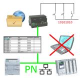
Über digitalen Eingang getriggerte DB-Sicherung/-Wiederherstellung ohne zusätzlichen PC über PN-Port auf FTP-Server
