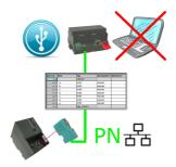
S7-SPS getriggerte DB-Sicherung/-Wiederherstellung ohne zusätzlichen PC über MPI/Profibus auf USB-Stick
