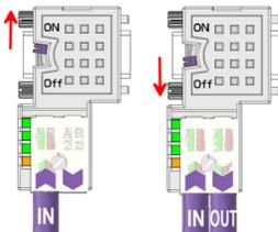
Die zuschaltbaren Abschlusswiderstände werden über den außenliegenden, von zwei Seiten leicht zugänglichen Schiebeschalter aktiviert.
